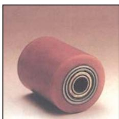
Il rullo transpalet particolarmente adatto per carichi elevati viene utilizzato con i supporti della serie pesantissima su pavimentazioni compatte e prive di ondulazioni. Può essere fornito con doppi cuscinetti a sfere schermati e, a richiesta con cuscinetti a tenuta stagna 2RS, oppure con sedi predisposte per il montaggio.
