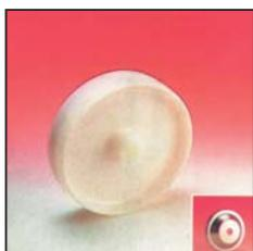
La ruota è in nylon 6 bianco di prima scelta, stampata ad iniezione, in grado di resistere a temperature da  $-30^{\circ}\text{C}$  a  $+80^{\circ}\text{C}$  con punte, per brevi periodi e con carico moderato, fino a  $+120^{\circ}\text{C}$ .
