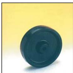
La ruota è monolitica di colore nero realizzata con una speciale resina che la rende idonea a temperature da  $-40^{\circ}\text{C}$  a  $+280^{\circ}\text{C}$ . Dotata di grande robustezza è in grado di resistere agli urti, ai solventi, agli acidi, agli olii. La ruota è con mozzo a foro liscio e viene abbinata ai supporti medi, pesanti e ai supporti con acciaio inox.
